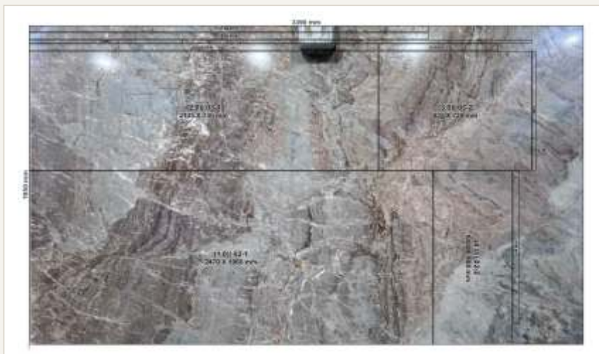
Plano de Corte para melhor aproveitamento da chapa.
